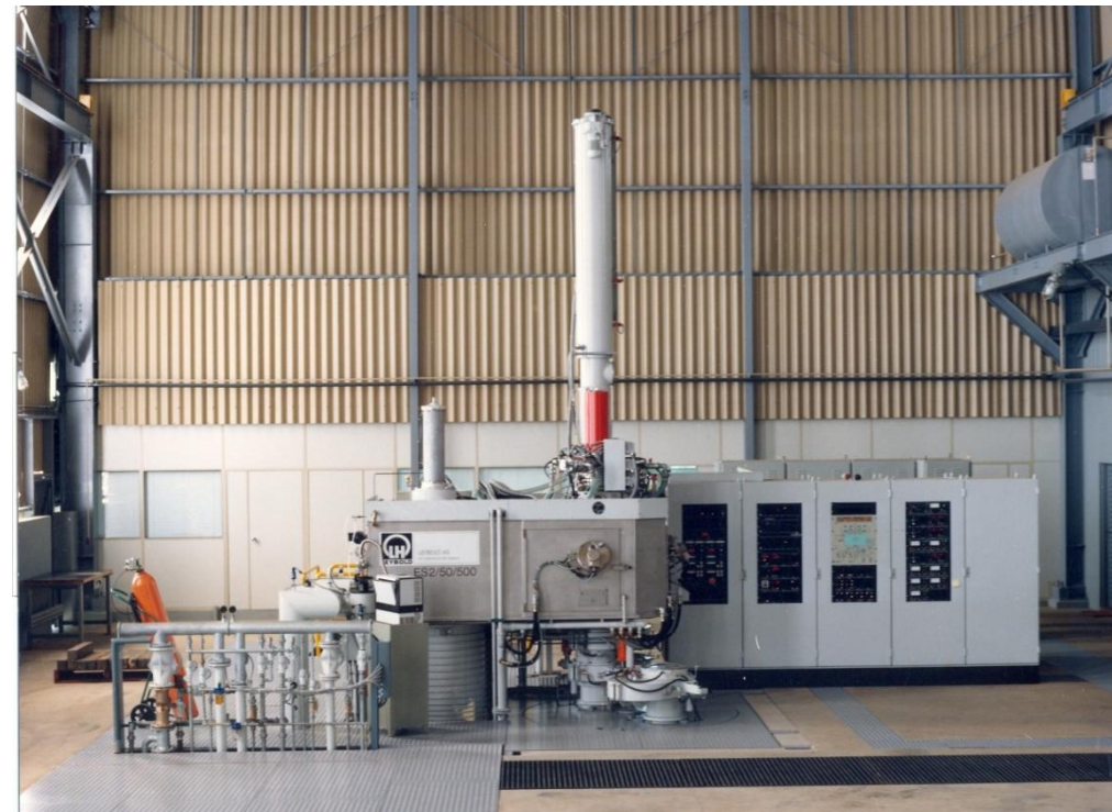
1º forno de fusão e refino da CBMM ES 2/50/260, 50.000 L/s
