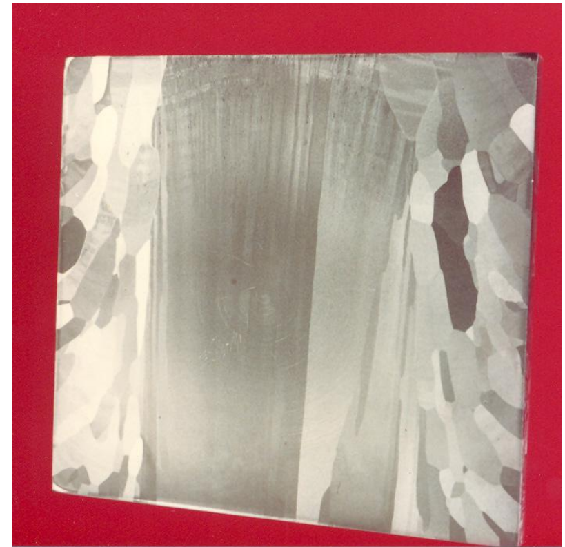
Corte longitudinal do lingote 'quase' um monocristal no centro do lingote
